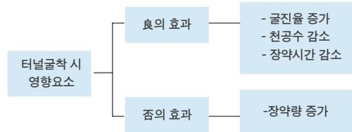
[그림 2] Bulk 폭약을 이용한 터널 굴착시 효과
